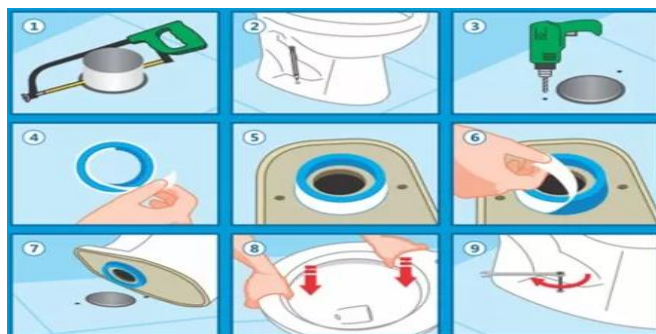
Figura 21: Processo de fixação das bacias sanitárias.
